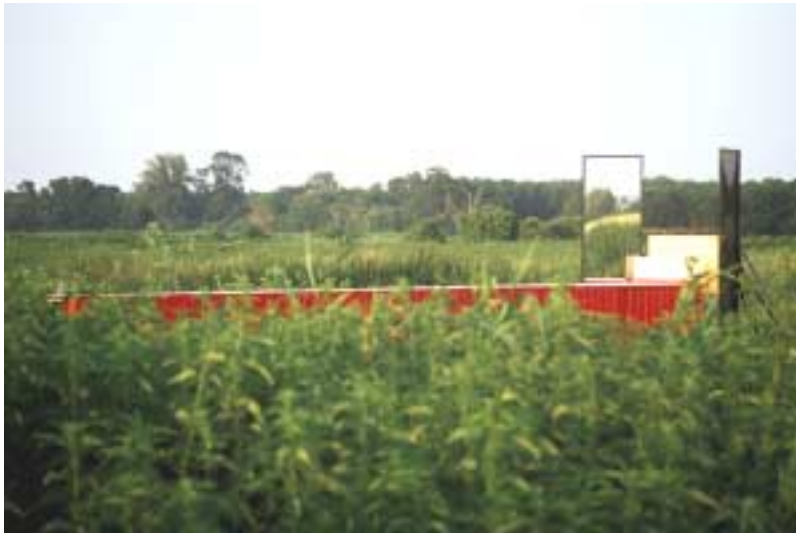
Abbildung 2: Die Versuchsanlage: Flugtunnel II (Länge 7,50m) ist umgeben von einheitlicher Vegetation, die als Attraktor wirkt, wenn Vögel durch den Tunnel vom Start (links) zu den Versuchsscheiben (rechts, vom Tunnel verdeckt) fliegen. Die beiden Spiegel (rechts im Bild) reflektieren Tageslicht symmetrisch, parallel und gleichmäßig auf die Versuchsscheiben. Der Tunnel ist drehbar gelagert, Flugrichtung der Vögel und Richtung des Sonnenlichtes liegen in einer Ebene, Sonne kommt immer „von hinten“ (hier von links).
