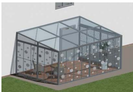
Solution de secours posée après coup : apposition d'autocollants sur les surfaces vitrées. Veillez à appliquer les supports à l'extérieur du jardin d'hiver (avec une qualité adaptée), au minimum sur les côtés latéraux de la construction. Le choix des motifs et de la couleur est libre. Dans l'idéal, il ne reste aucune surface libre ayant une taille plus grande que la paume d'une main.
